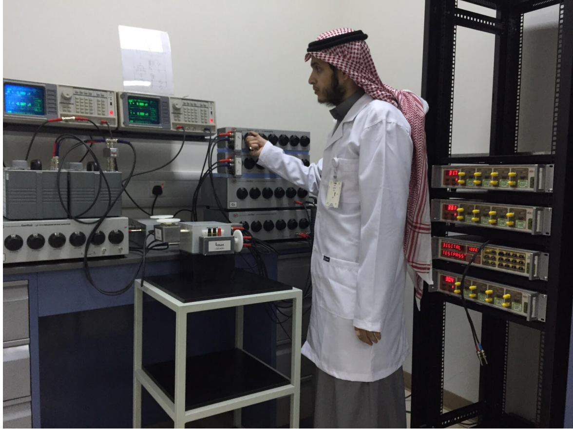
خريج يقوم بقياس الملفات بواسطة قنطرة ماكسويل الهيئة السعودية المواصفات والمقاييس والجودة
