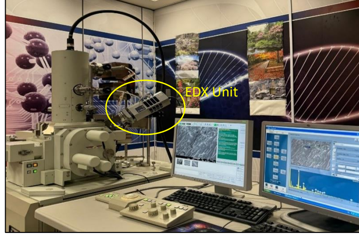
الشكل 7: المجهر الإلكتروني الماسح الذي تم استخدامه
