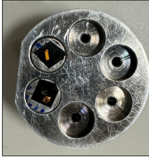
الشكل 9: تحضير العينات قبل إدخالها إلى المجهر الإلكتروني الماسح
